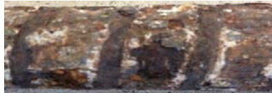
(d) Exposure time 90 days (7.5 % mass loss)
